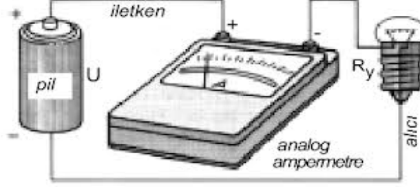
Şekil 2.3 Avometre ile akım ölçmek
