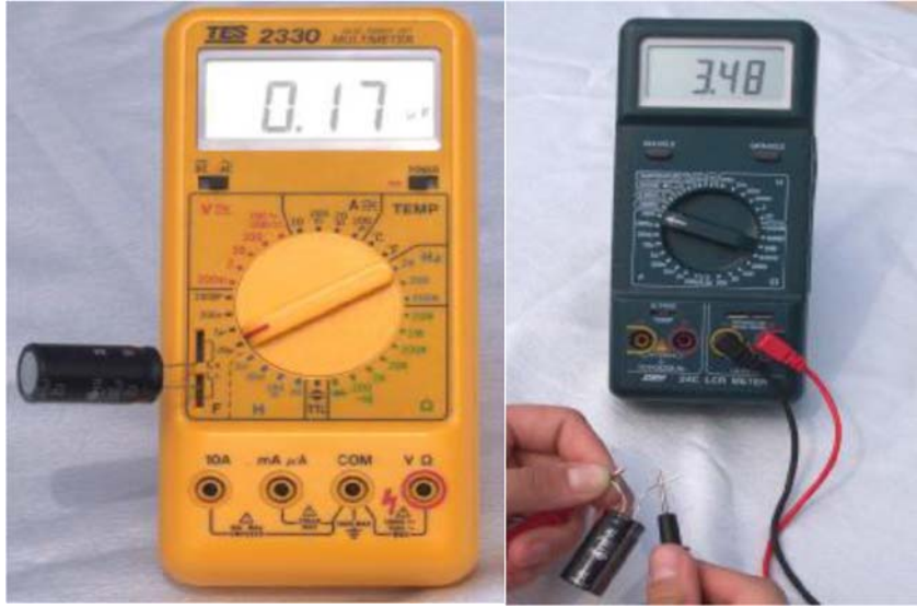
Şekil 2: Endüktans ölçümü LCRmetre bağlantısı
