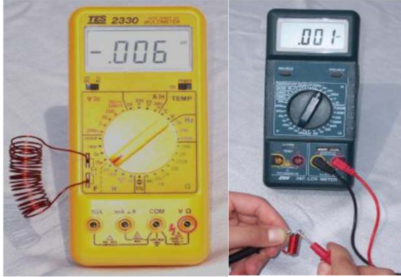
Şekil 1: Endüktans ölçümü LCRmetre bağlantısı
