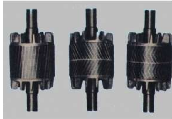
Şekil- 9.4 : Kısa devre çubuklu rotor.
