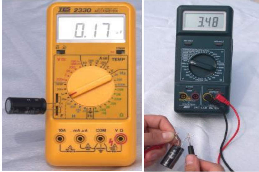
Şekil 2: Endüktans ölçümü LCRmetre bağlantısı
